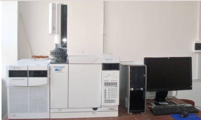
Sistem complet gaz cromatograf cu autoinjector și detectori, cuplat cu spectrometru de masă - Agilent Technologies
