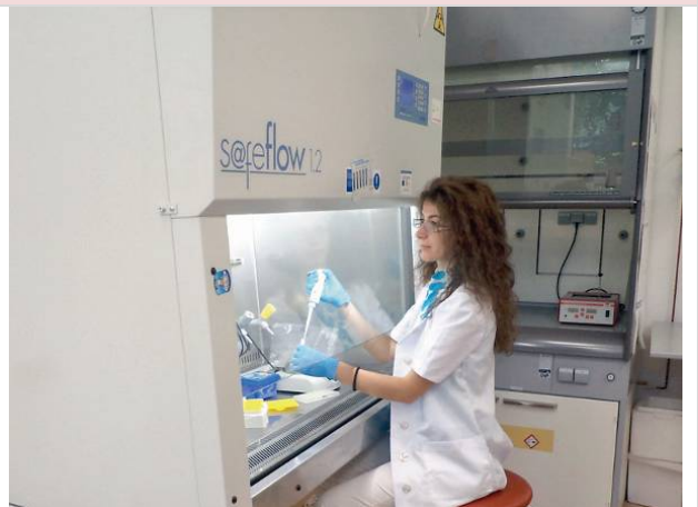
Hote cu flux laminar - Euroclone
