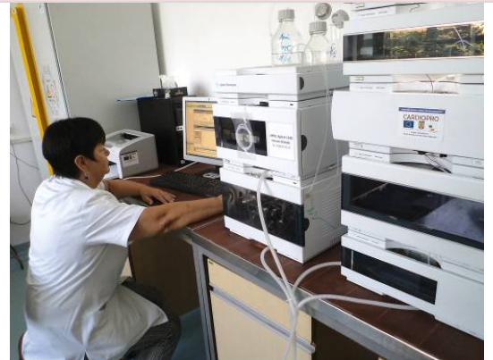
Cromatograf lichid de înaltă performanță (UHPLC) cu sistem de injecție a probei și detectori multimod - Agilent Technologies
