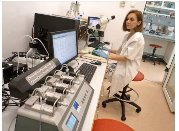
Echipment complex pentru miografie izometrica - DMT
