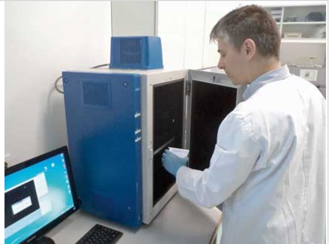
Aparat pentru preluare imagini in fluorescenta, luminiscenta, UV si vizibil LAS-4000 - GE Healthcare
