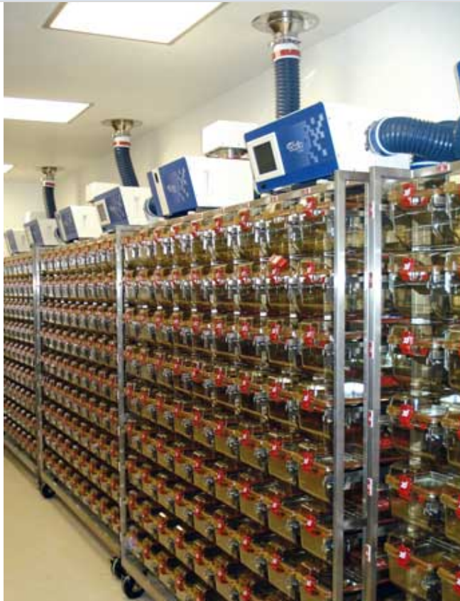
Rack-uri ventilate cu custi pentru animale mici de laborator, Allentown
