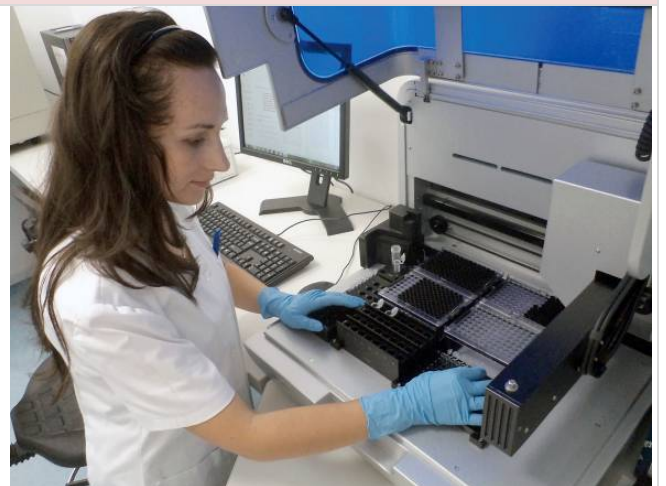
Statie de pipetare - Qiagen
