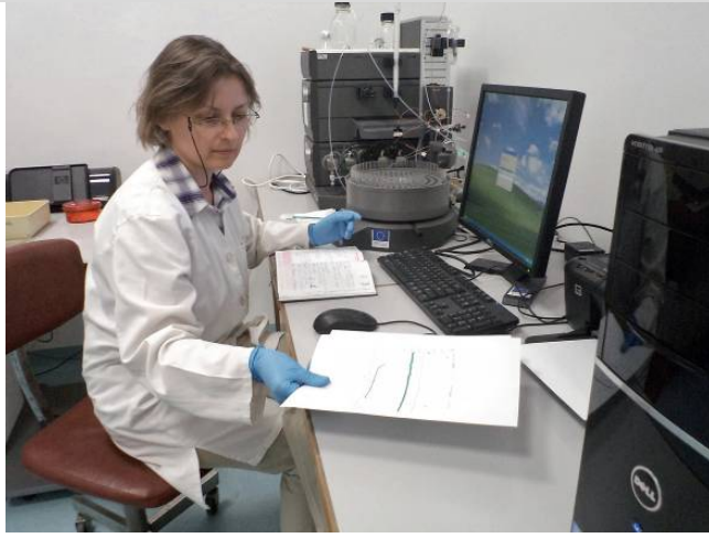
Sistem pentru cromatografie lichidă rapidă pentru proteine (FPLC), cu detector UV și colector de fracțiuni - GE Healthcare
