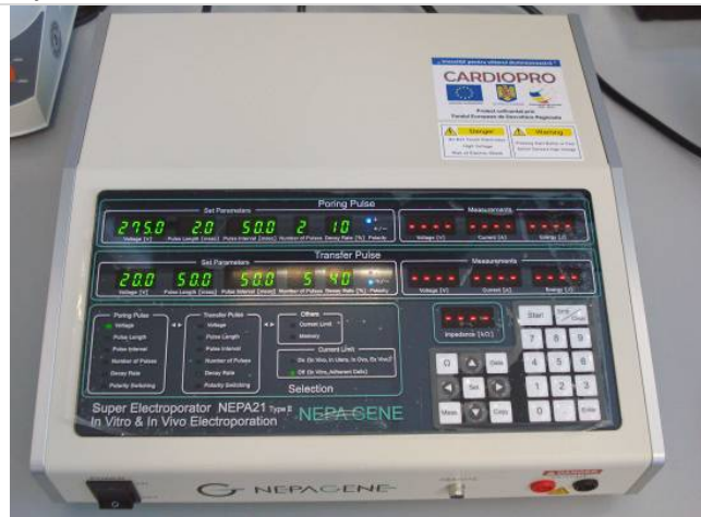
Aparat electroporare in vitro si in vivo - NepaGene
