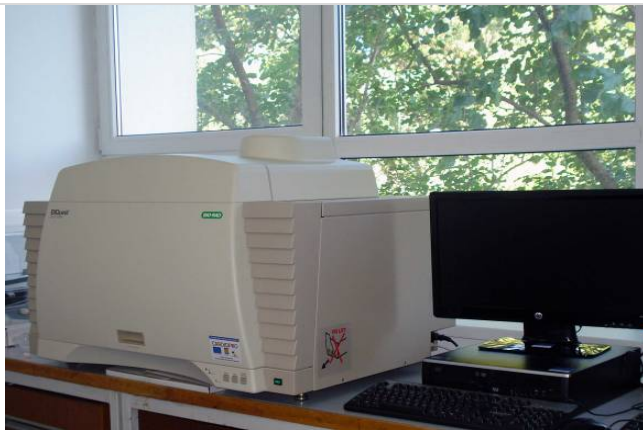
Sistem automat de excizare spoturi - Bio-Rad
